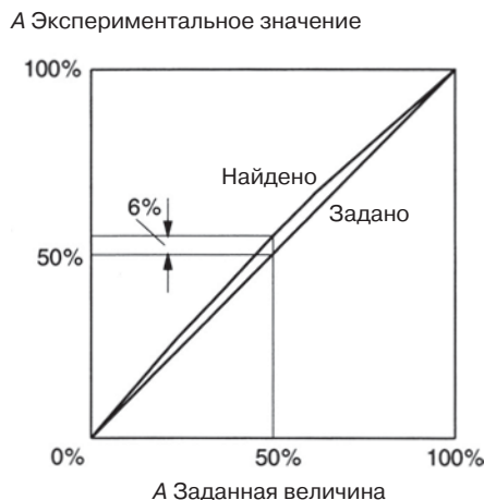
Рис. 4.10. Типичные отклонения экспериментальных значений от заданных величин в градиентной системе низкого давления
