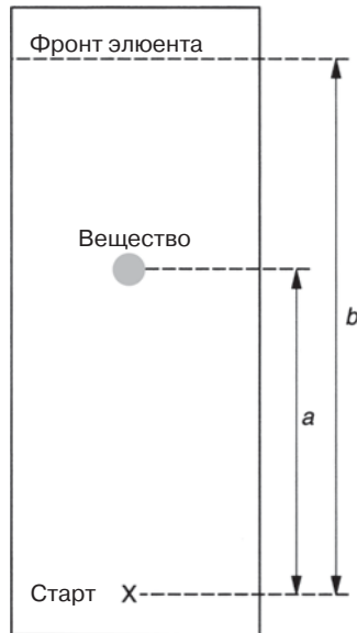
Рис. 5.24. Схема, поясняющая определение Rf-значений
