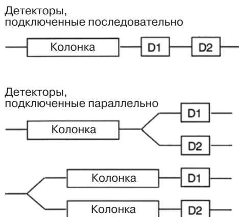
Рис. 2.13. Обычные конфигурации мультidetекторных систем
