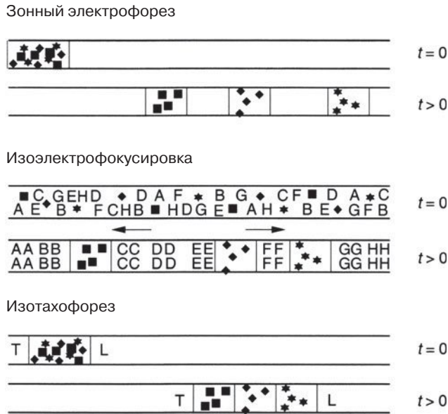
Рис. 7.7. Схематическое представление зонного электрофореза, изоэлектрофокусировки и изотахофореза
