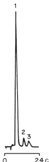
Рис. 23.3. Высокоскоростное разделение гипотензивного лекарственного препарата (с разрешения F. Ergi, Novartis). Условия: образец — 10 мкл раствора капсулы в искусственном желудочном соке, колонка 100 \times 2,1 мм, сорбент Spherisorb RP-18, 5 мкм, подвижная фаза ацетонитрил — 0,4 М фосфорная кислота (85:15), скорость потока 3 мл/мин, УФ, 260 нм, объем ячейки детектора 2,8 мкл, длина оптического пути 10 мм, постоянная времени 0,1 с (98 %). Пики: 1 — клопамид, 2 — дигидроэргокристин, 3 — резерпин
