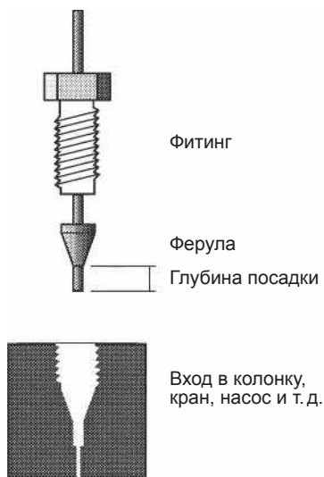
Рис. 4.4. Соединения для повышенных давлений
