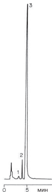
Рис. 11.4. Разделение нитрата и бромида из экстракта капустного листа на аминофазе. Условия: образец — 20 мкл экстракта, полученного после гомогенизации, осаждения белков и фильтрации, колонка 250 \times 3,2 мм, сорбент LiChrosorb \text{NH}_2 , 5 мкм, подвижная фаза 1 % \text{KH}_2\text{PO}_4 в воде, доведенная \text{H}_3\text{PO}_4 до pH 3, скорость подвижной фазы 1 мл/мин, УФ, 210 нм. Пики: 1 — нитрил (образовавшийся из нитрата в результате пробоподготовки), 2 — бромид, 3 — нитрат
