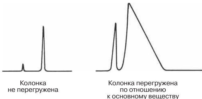
Рис. 19.2. Перегрузка колонки при анализе микропримесей
