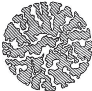
Рис. 2.5. Пористая структура частицы сорбента
