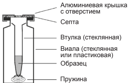
Рис. 4.7. Подпружиненная виала с конической вставкой для небольших объемов образца
