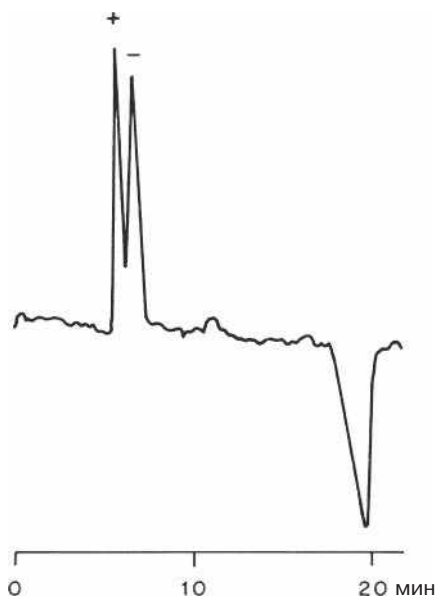
Рис. 22.2. Разделение энантиомеров N -(1-фенилэтил)фталевой кислоты с хиральным ион-парным реагентом (печатается с разрешения из С. Pettersson, J. Chromatogr. , 316 , 553 (1984)). Условия: сорбент LiChrosorb SI 100, 5 мкм, подвижная фаза хлористый метилен — бутан-1,2-диол (99:1), содержащий 0,35 мМ хинина и 0,35 мМ уксусной кислоты; УФ-детектор. Отрицательный пик на 19 минуте — системный пик
