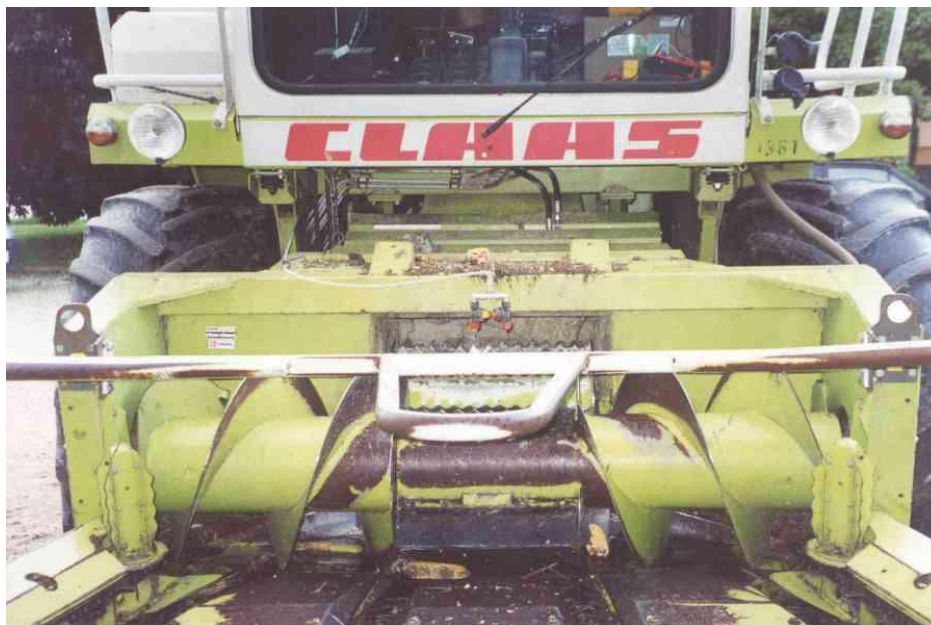
Фото 2. Схема установки распылителей перед приемным барабаном жатки.
