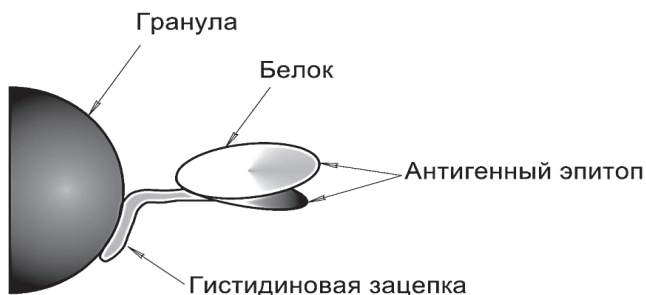
Рис. 29. Схема прикрепления белка с гистиридиновым фрагментом к грануле в аффинной колонке [24]
