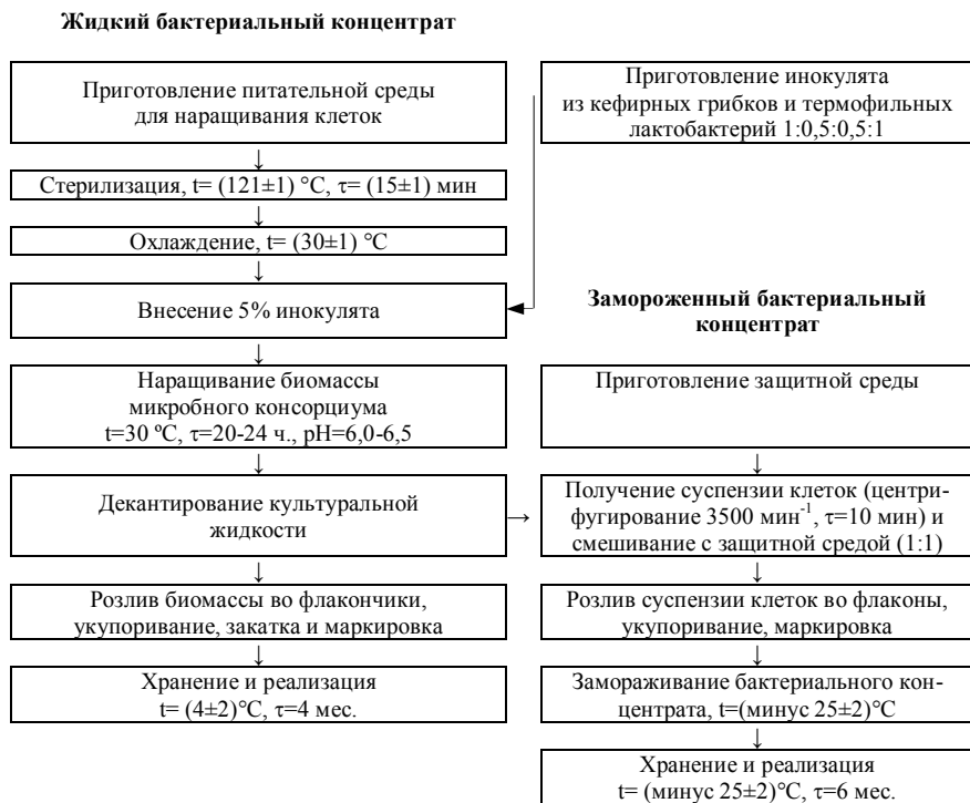
Рисунок 5 – Технологическая схема производства бактериального концентрата микробного консорциума
