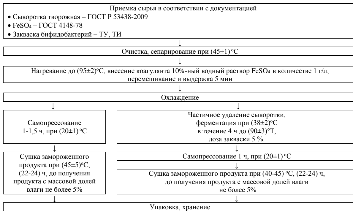
Рисунок 4 – Технологическая схема производства сухого КСБ, обогащенного железом
